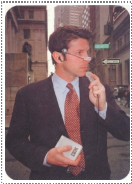
착용형 정보검색과 자료기입 하드웨어 이 착용형 개인용 컴퓨터는 머리와 허리 부분에 설치된다. 이 실업가는 자료를 기입하고 손놀림만으로 정보를 검색한다
